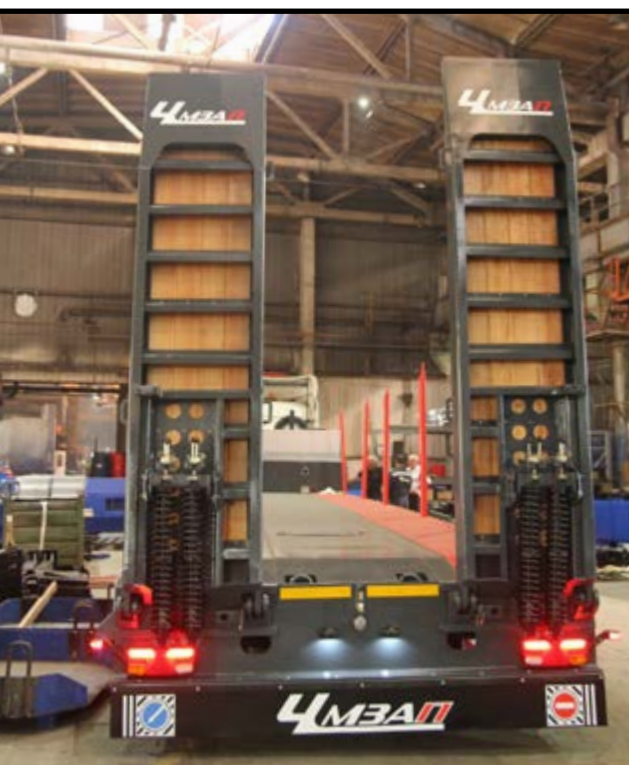
Обновлённые облегчённые трапы с инновационным креплением при помощи подвижной пластины
