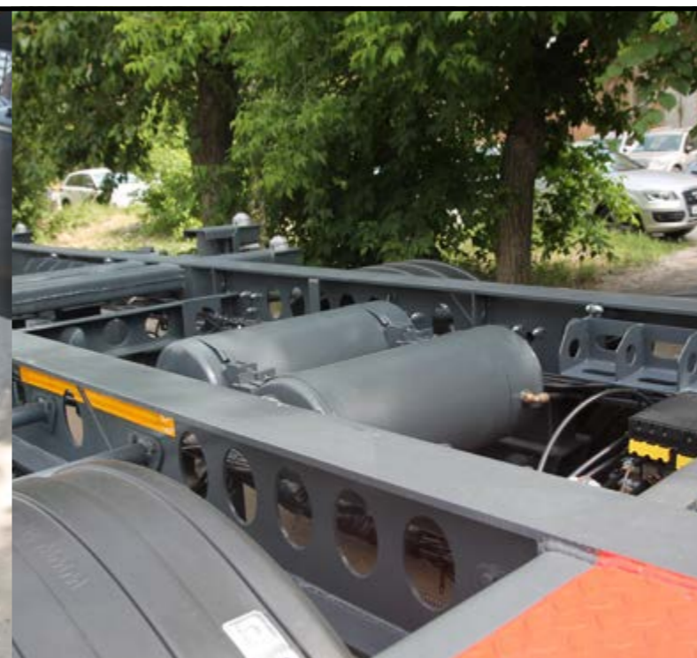
Облегчённая рама, которая позволяет снизить вес и нагрузку на дорогу и тягач; перфорация лонжеронов
