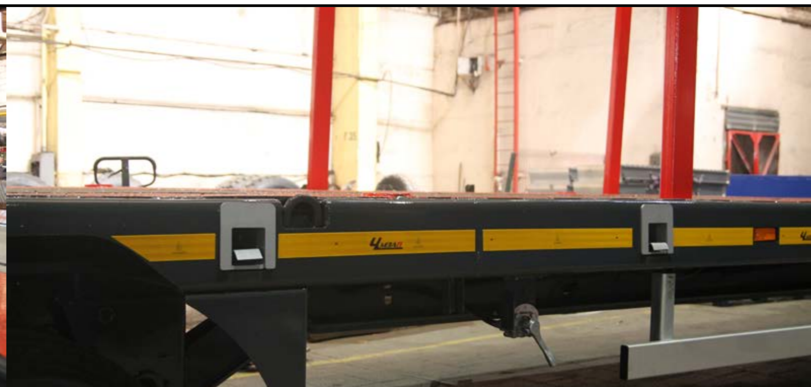
Утапливаемые обновлённые увязочные петли, выдвигаемые уширители, SmartBoard фирмы WABCO
