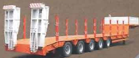
Полуприцеп - тяжеловоз ЧМЗАП 99904-010Т Грузоподъемность - 60 т.
