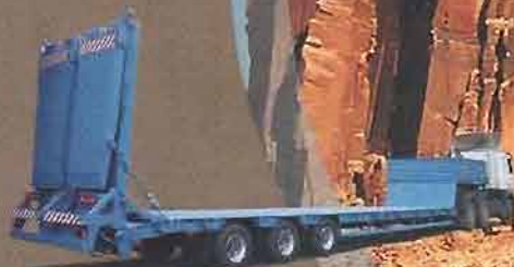
Полуприцеп - тяжеловоз ЧМЗАП 9906.04-041 Грузоподъемность - 36,5 т.
