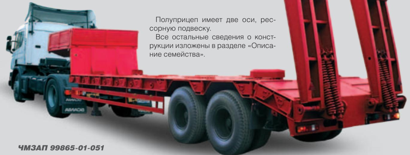
Полуприцеп имеет две оси, рессорную подвеску. Все остальные сведения о конструкции изложены в разделе «Описание семейства».
