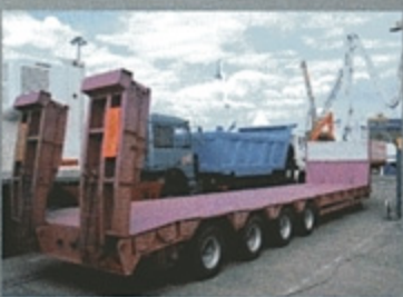
ПОЛУПРИЦЕП ЧМЗАП-999030-033, 54 т., 10500×2500 (3000) мм, погруз. высота 920 мм.
