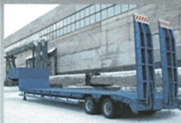
ПОЛУПРИЦЕП ЧМЗАП-938530-037УУБ2, 24 т., 11405×2500 (3000) мм, погруз. высота 885 мм.
