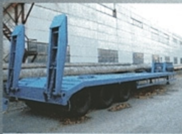
ПОЛУПРИЦЕП ЧМЗАП-990640-070, 39.8 т., 10000×3000 мм, погруз. высота 1200 мм.
