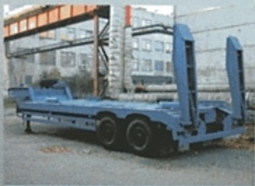
ПОЛУПРИЦЕП ЧМЗАП-99865-01-012, 39.4 т., 7480×3150 мм, погруз. высота 1170 мм.
