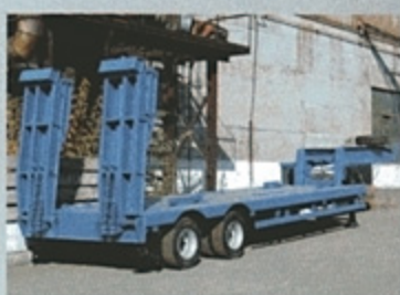
ПОЛУПРИЦЕП ЧМЗАП-93853-033ДТ, 25.5 т., 7600×2500 мм, погруз. высота 885 мм.
