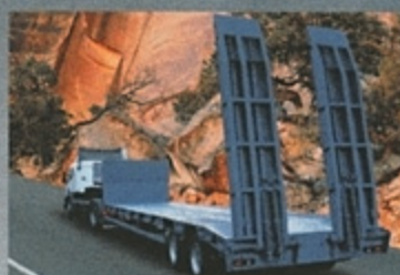
ПОЛУПРИЦЕП ЧМЗАП-93853-030МТУ, 24 т., 8400×2500 (3000) мм, погруз. высота 885 мм.
