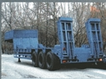
ПОЛУПРИЦЕП ЧМЗАП-999000-073-01, 60 т., 9190×2500 (3150) мм, погруз. высота 1225 мм.
