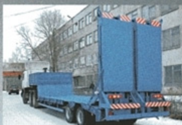
ПОЛУПРИЦЕП ЧМЗАП-93853-030, 24 т., 7600×2500 (3000) мм, погруз. высота 885 мм.
