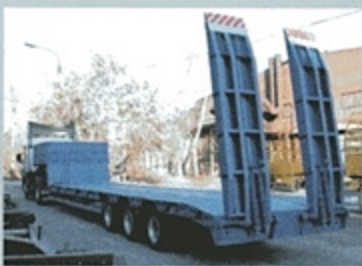
ПОЛУПРИЦЕП ЧМЗАП-990640-042-02, 38 т., 11800×2500 (3000) мм, погруз. высота 885 мм.
