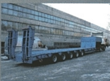
ПОЛУПРИЦЕП ЧМЗАП-999040-011, 60 т., 11700×2500 (3000) мм, погруз. высота 950 мм.
