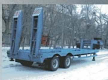
ПОЛУПРИЦЕП ЧМЗАП-93853-033, 26.2 т., 7600×2500 мм, погруз. высота 885 мм.
