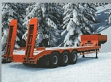
ПОЛУПРИЦЕП ЧМЗАП-999000-052, 52 т., 9310×3150 мм, погруз. высота 1350 мм.
