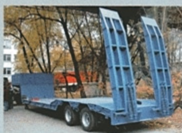
ПОЛУПРИЦЕП ЧМЗАП-938530-037НРК, 25 т., 6000+4000×2500 (3000) мм, погруз. высота 630 мм.
