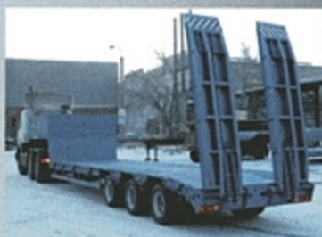
ПОЛУПРИЦЕП ЧМЗАП-990640-052МТ2, 38 т., 9300×2500 (3000) мм, погруз. высота 885 мм.
