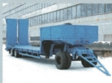
ПОЛУПРИЦЕП ЧМЗАП-93853-030 с подкраном, 24 т., 7600×2500 (3000) мм, погруз. высота 885 мм.
