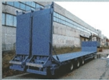
ПОЛУПРИЦЕП ЧМЗАП-990640-042, 35 т., 11800×2500 (3000) мм, погруз. высота 885 мм.
