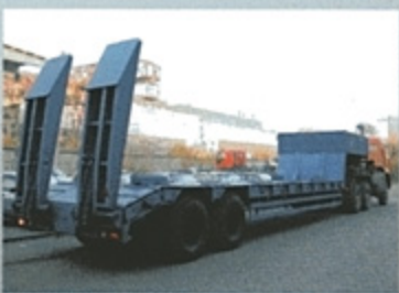
ПОЛУПРИЦЕП ЧМЗАП-99865-01-053, 41 т., 10070×2500 (3000) мм, погруз. высота 1225 мм.
