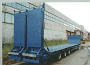
ПОЛУПРИЦЕП ЧМЗАП-990640-042, 35 т., 11800*2500 (3000) мм, погруз. высота 885 мм.
