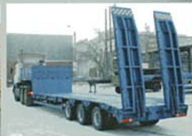
ПОЛУПРИЦЕП ЧМЗАП-990640-052MT2, 38 т., 9300*2500 (3000) мм, погруз. высота 885 мм.
