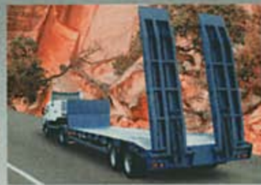
ПОЛУПРИЦЕП ЧМЗАП-93853-030MTU, 24 т., 8400*2500 (3000) мм, погруз. высота 885 мм.
