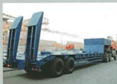
ПОЛУПРИЦЕП ЧМЗАП-99865-01-053, 41 т., 10070*2500 (3000) мм, погруз. высота 1225 мм.
