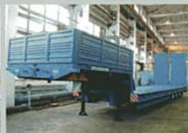
ПОЛУПРИЦЕП ЧМЗАП-990640-046, 37 т., 11800*3000 мм, погруз. высота 885 мм.
