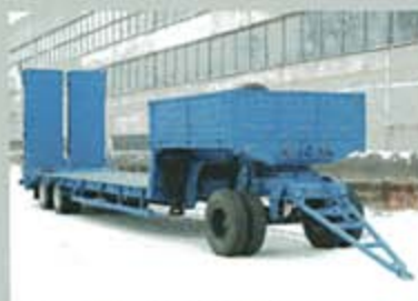
ПОЛУПРИЦЕП ЧМЗАП-93853-030 с подствел, 24 т., 7600*2500 (3000) мм, погруз. высота 885 мм.
