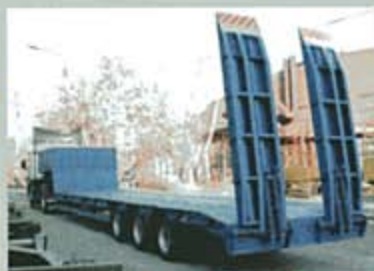
ПОЛУПРИЦЕП ЧМЗАП-990640-042-02, 38 т., 11800*2500 (3000) мм, погруз. высота 885 мм.
