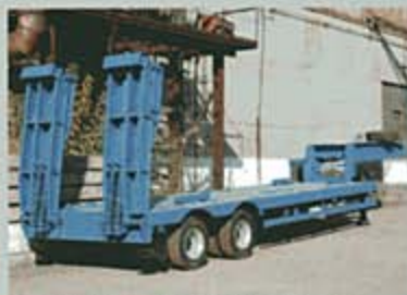
ПОЛУПРИЦЕП ЧМЗАП-93853-033DT, 25.5 т., 7600*2500 мм, погруз. высота 885 мм.
