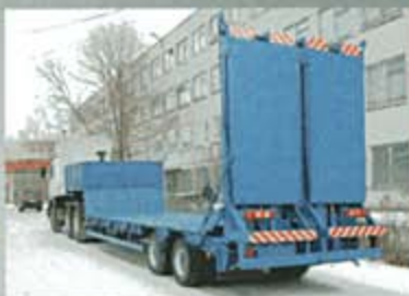
ПОЛУПРИЦЕП ЧМЗАП-93853-030, 24 т., 7600*2500 (3000) мм, погруз. высота 885 мм.
