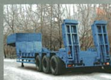
ПОЛУПРИЦЕП ЧМЗАП-999000-073-01, 60 т., 9190*2500 (3150) мм, погруз. высота 1225 мм.
