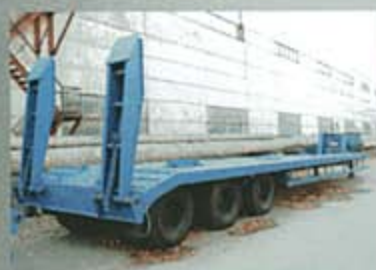
ПОЛУПРИЦЕП ЧМЗАП-990640-070, 39.8 т., 10000*3000 мм, погруз. высота 1200 мм.
