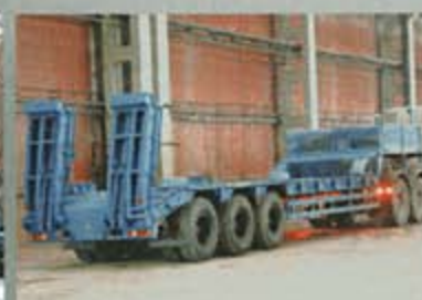
ПОЛУПРИЦЕП ЧМЗАП-999000-073-01HC, 60 т., 9260*2500 (3150) мм, погруз. высота 1275 мм.
