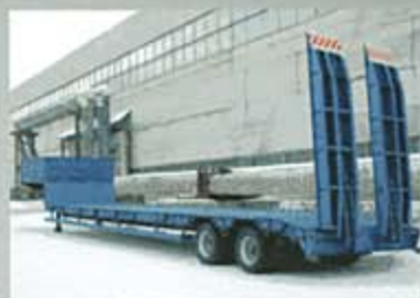
ПОЛУПРИЦЕП ЧМЗАП-938530-037YU62, 24 т., 11405*2500 (3000) мм, погруз. высота 885 мм.
