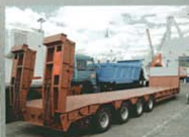
ПОЛУПРИЦЕП ЧМЗАП-999030-033, 54 т., 10500*2500 (3000) мм, погруз. высота 920 мм.
