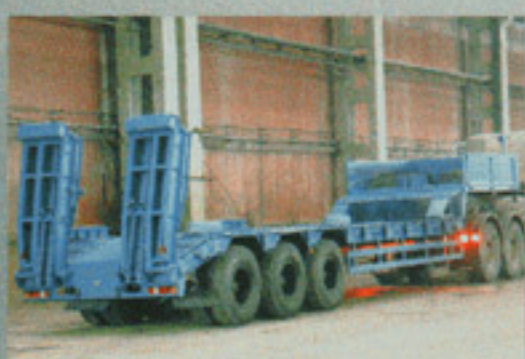
ПОЛУПРИЦЕП ЧМЗАП-999000-073-01НС, 60 т., 9260×2500 (3150) мм, погруз. высота 1275 мм.
