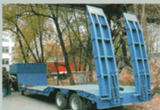
ПОЛУПРИЦЕП ЧМЗАП-938530-037НРК, 25 т., 6000+4000×2500 (3000) мм, погруз. высота 630 мм.
