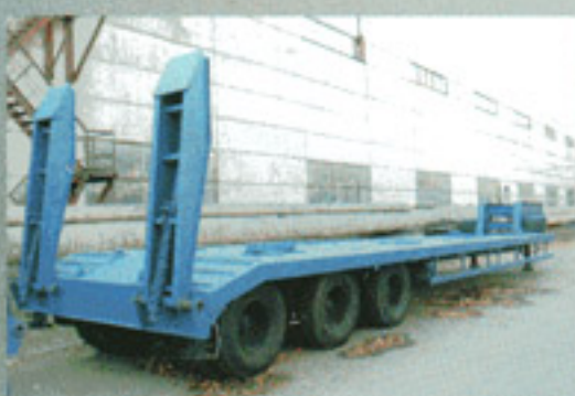
ПОЛУПРИЦЕП ЧМЗАП-990640-070, 39.8 т., 10000×3000 мм, погруз. высота 1200 мм.
