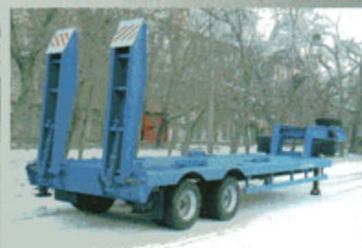
ПОЛУПРИЦЕП ЧМЗАП-93853-033, 26.2 т., 7600×2500 мм, погруз. высота 885 мм.
