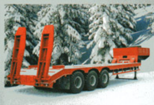
ПОЛУПРИЦЕП ЧМЗАП-999000-052, 52 т., 9310×3150 мм, погруз. высота 1350 мм.
