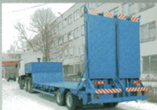
ПОЛУПРИЦЕП ЧМЗАП-93853-030, 24 т., 7600×2500 (3000) мм, погруз. высота 885 мм.
