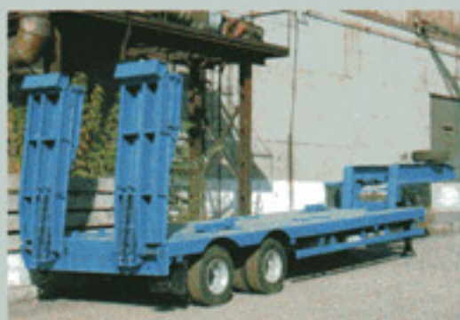
ПОЛУПРИЦЕП ЧМЗАП-93853-033ДТ, 25.5 т., 7600×2500 мм, погруз. высота 885 мм.
