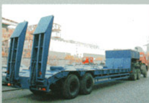
ПОЛУПРИЦЕП ЧМЗАП-99865-01-053, 41 т., 10070×2500 (3000) мм, погруз. высота 1225 мм.
