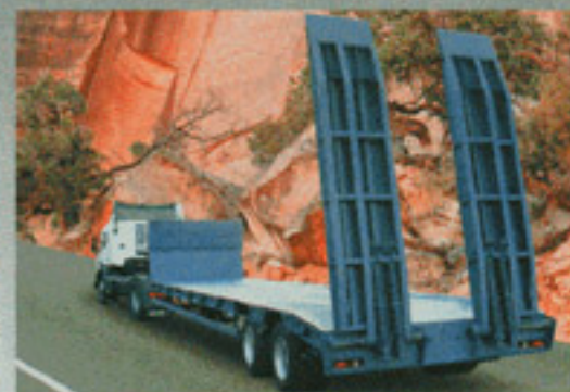
ПОЛУПРИЦЕП ЧМЗАП-93853-030MTU, 24 т., 8400×2500 (3000) мм, погруз. высота 885
