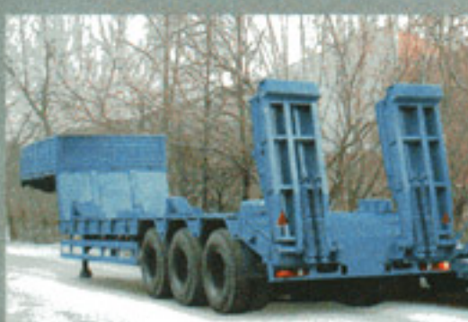
ПОЛУПРИЦЕП ЧМЗАП-999000-073-01, 60 т., 9190×2500 (3150) мм, погруз. высота 1225 мм.
