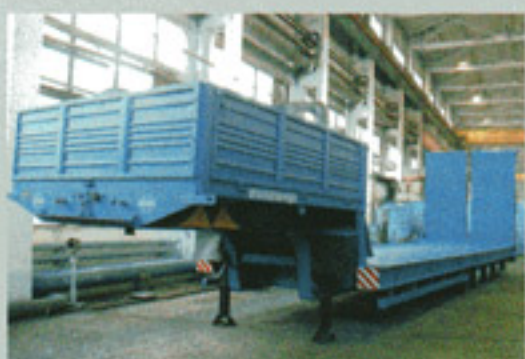
ПОЛУПРИЦЕП ЧМЗАП-990640-046, 37 т., 11800×3000 мм, погруз. высота 885 мм.
