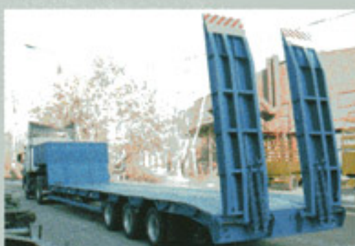
ПОЛУПРИЦЕП ЧМЗАП-990640-042-02, 38 т., 11800×2500 (3000) мм, погруз. высота 885 мм.
