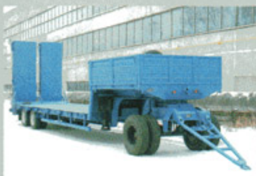
ПОЛУПРИЦЕП ЧМЗАП-93853-030 с подкстел, 24 т., 7600×2500 (3000) мм, погруз. высота 885 мм.
