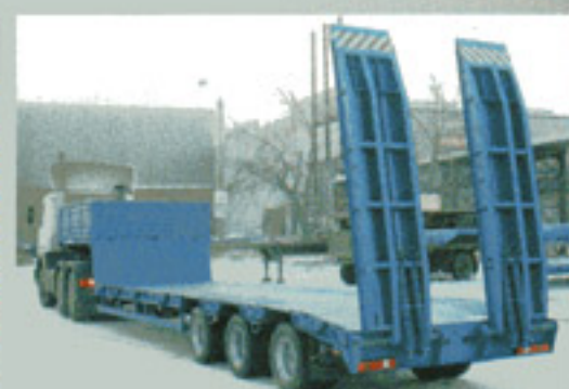
ПОЛУПРИЦЕП ЧМЗАП-990640-052MT2, 38 т., 9300×2500 (3000) мм, погруз. высота 885 мм.
