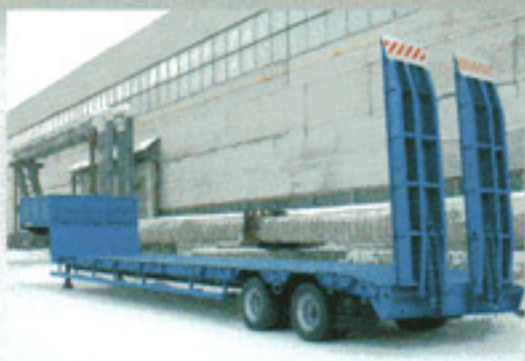
ПОЛУПРИЦЕП ЧМЗАП-938530-037УУБ2, 24 т., 11405×2500 (3000) мм, погруз. высота 885 мм.
