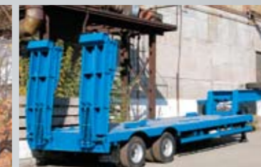
ПОЛУПРИЦЕП ЧМЗАП-93853-033ДТ, 25.5 т., 7600×2500 мм, погруз. высота 885 мм.
