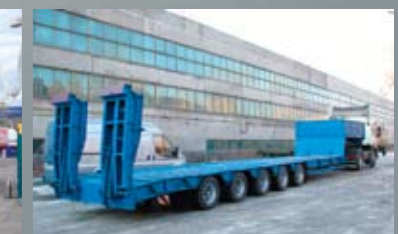
ПОЛУПРИЦЕП ЧМЗАП-999040-011, 60 т., 11700×2500 (3000) мм, погруз. высота 950 мм.
