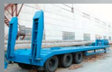
ПОЛУПРИЦЕП ЧМЗАП-990640-070, 39.8 т., 10000×3000 мм, погруз. высота 1200 мм.
