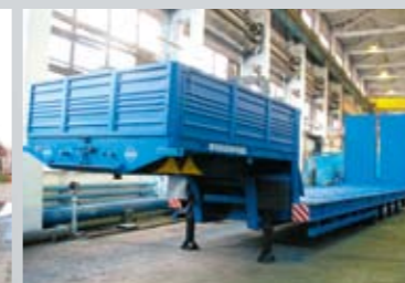
ПОЛУПРИЦЕП ЧМЗАП-990640-046, 37 т., 11800×3000 мм, погруз. высота 885 мм.
