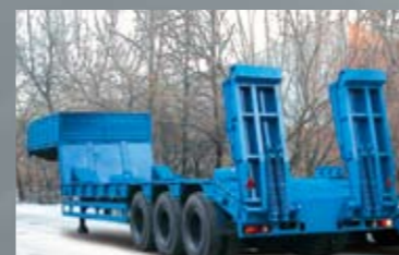
ПОЛУПРИЦЕП ЧМЗАП-999000-073-01, 60 т., 9190×2500 (3150) мм, погруз. высота 1225 мм.
