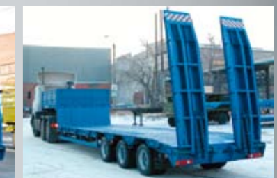
ПОЛУПРИЦЕП ЧМЗАП-990640-052МТ2, 38 т., 9300×2500 (3000) мм, погруз. высота 885 мм.
