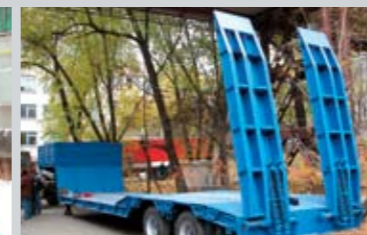
ПОЛУПРИЦЕП ЧМЗАП-938530-037НРК, 25 т., 6000+4000×2500 (3000) мм, погруз. высота 630 мм.
