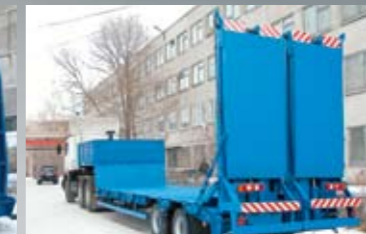
ПОЛУПРИЦЕП ЧМЗАП-93853-030, 24 т., 7600×2500 (3000) мм, погруз. высота 885 мм.
