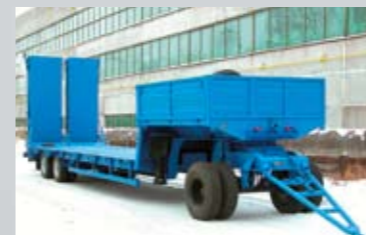
ПОЛУПРИЦЕП ЧМЗАП-93853-030 с подж.тел., 24 т., 7600×2500 (3000) мм, погруз. высота 885 мм.
