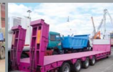
ПОЛУПРИЦЕП ЧМЗАП-999030-033, 54 т., 10500×2500 (3000) мм, погруз. высота 920 мм.
