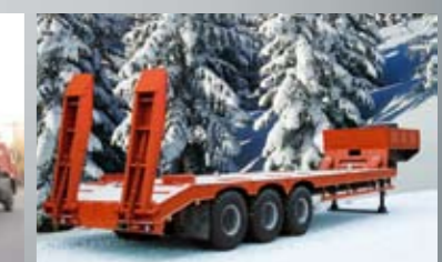
ПОЛУПРИЦЕП ЧМЗАП-999000-052, 52 т., 9310×3150 мм, погруз. высота 1350 мм.
