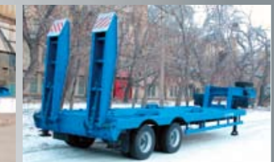
ПОЛУПРИЦЕП ЧМЗАП-93853-033, 26.2 т., 7600×2500 мм, погруз. высота 885 мм.
