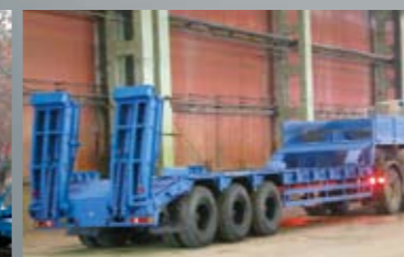
ПОЛУПРИЦЕП ЧМЗАП-999000-073-01НС, 60 т., 9260×2500 (3150) мм, погруз. высота 1275 мм.
