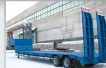
ПОЛУПРИЦЕП ЧМЗАП-938530-037УУБ2, 24 т., 11405×2500 (3000) мм, погруз. высота 885 мм.
