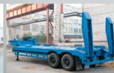
ПОЛУПРИЦЕП ЧМЗАП-99865-01-012, 39.4 т., 7480×3150 мм, погруз. высота 1170 мм.
