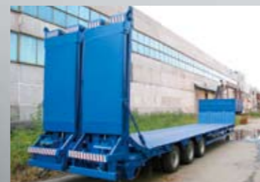
ПОЛУПРИЦЕП ЧМЗАП-990640-042, 35 т., 11800×2500 (3000) мм, погруз. высота 885 мм.
