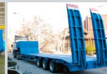
ПОЛУПРИЦЕП ЧМЗАП-990640-042-02, 38 т., 11800×2500 (3000) мм, погруз. высота 885 мм.
