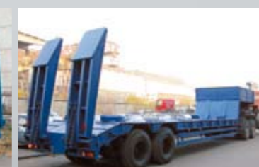
ПОЛУПРИЦЕП ЧМЗАП-99865-01-053, 41 т., 10070×2500 (3000) мм, погруз. высота 1225 мм.
