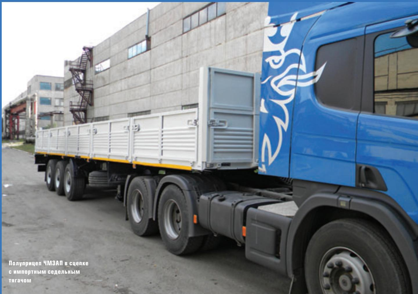
Полуприцеп ЧМЗАП в сцепке с импортным седельным тягачом
