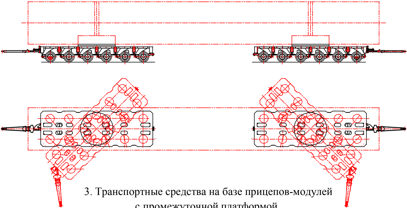
706000+706000, оборудованные опорно-поворотными устройствами для перевозки груза несущей конструкции
