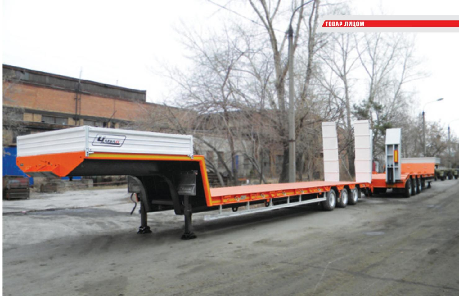
тва ЧМЗАП-99064 по спецификациям -042, -052 грузоподъёмностью от 37 до 45 тонн с уширителями грузовой платформы.
