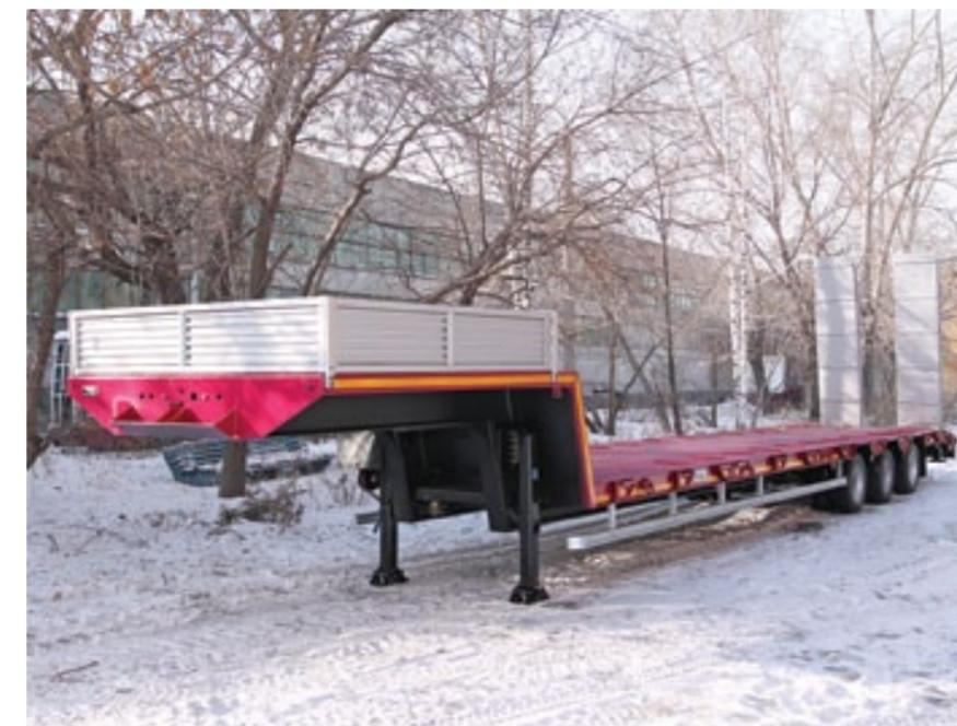
Низкорамный полуприцеп. Ровная грузовая платформа над колёсами.
