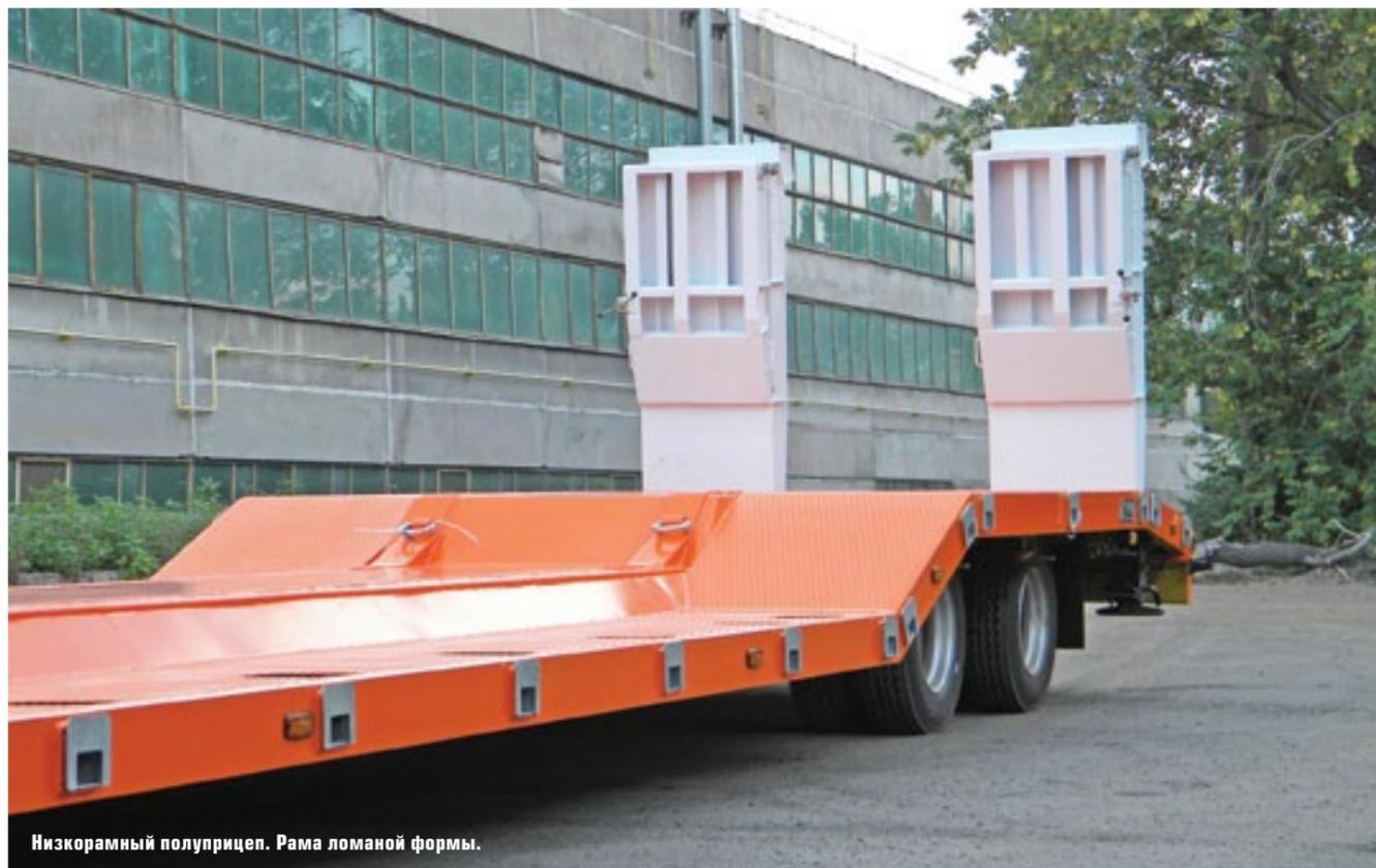
Низкорамный полуприцеп. Рама ломаной формы.
