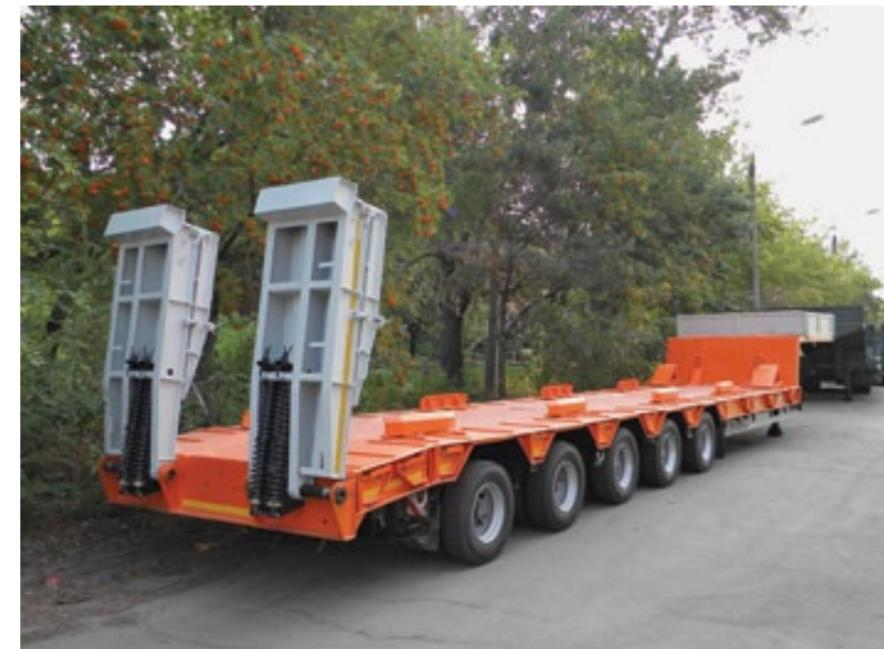
Плакты противоскольжения, отбойные бруссы и противооткатные упоры на грузовой платформе полуприцепа ЧМЗАП 99904-011-НУ
