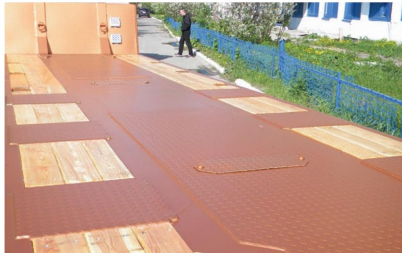
Деревянные настилы на грузовой платформе полуприцепа ЧМЗАП 99904-011-В
