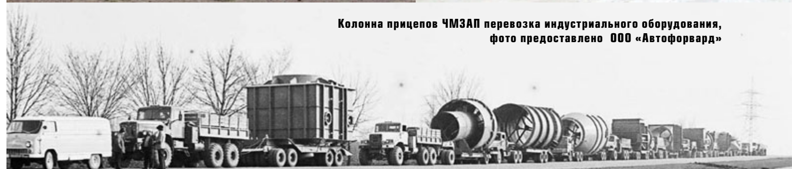
2 место. Перевозка крупногабаритного груза на раздвижных полуприцепах ЧМЗАП-93371-010-02
