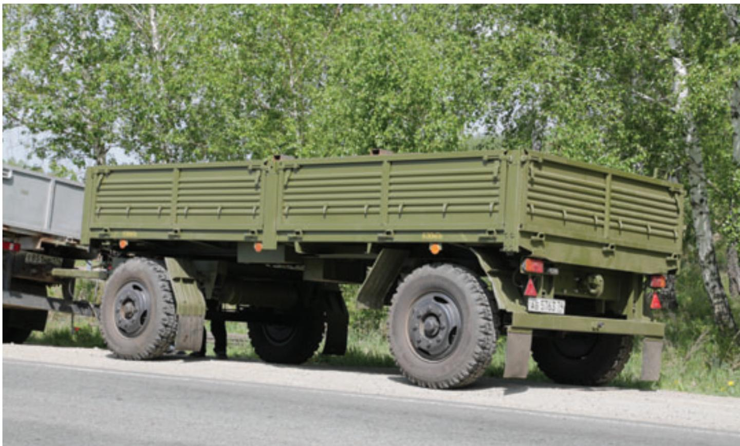
Предъявительские испытания прицепной техники ОАО «ЧМЗАП» проводятся на 12 видах аттестованного испытательского оборудования. Это контроль окрашивания, проверка работы тормозной системы, электрооборудования и дополнительного оборудования, контроль моментов затяжки и резьбовых соединений, проверка смазки, пробеговые испытания. Лабораторные испытания включают в себя химические анализы металла и лакокрасочных материалов. Покупные изделия проходят серьезный входной контроль.
