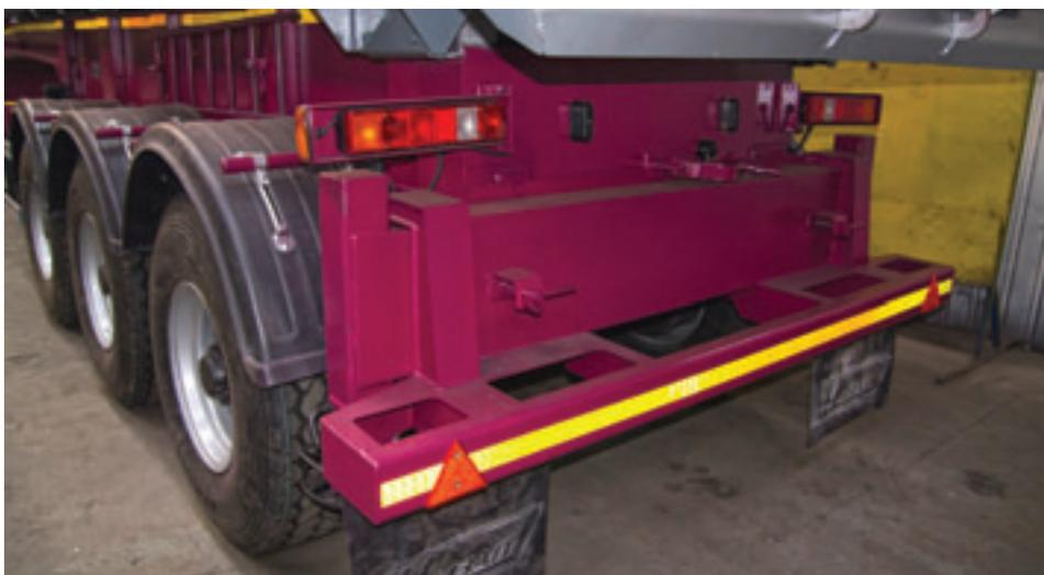
**Задние выдвигаемые аутригеры, увеличивающие устойчивость полуприцепа при разгрузке**
