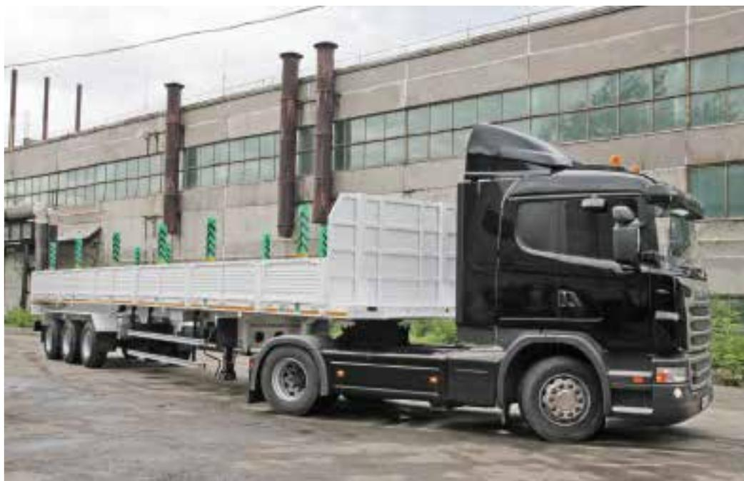
Высокорамный **ЧМЗАП 99903-041 ШПК** с длиной платформы 11 м. грузоподъемностью 55 т. для эксплуатации в условиях бездорожья и низких температур в «усиленном» исполнении.
