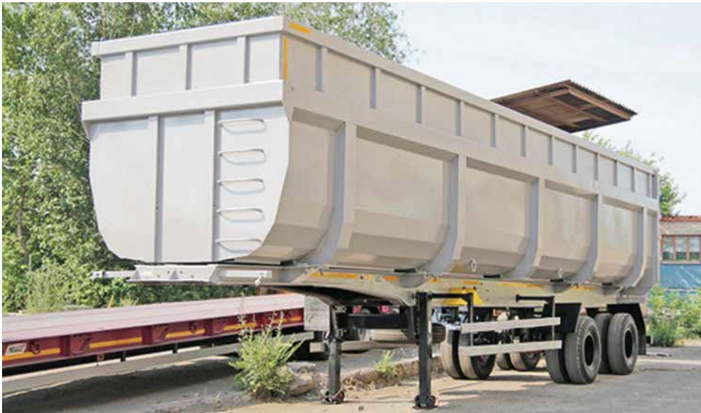
Крупная партия металловозов с распашными воротами и типом кузова half-pipe изготовлена для крупнейшей сети ломо-перерабатывающих предприятий. По бокам кузова применено усиление, которое обеспечивает дополнительную жесткость и защищает борта от продавливания при транспортировке металлолома. Съемный кузов можно при необходимости оставить в месте загрузки и забрать спустя какое-то время.
