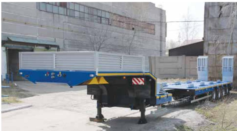
Многоосный полуприцеп-тяжеловоз **ЧМЗАП 99903-035 Т** с раздвижной рамой грузоподъемностью 51,5 т. Длина грузовой платформы - 10040 мм, при раздвижке увеличивается до 17040 мм. Полуприцеп оборудован выдвигаемыми уширителями грузовой платформы. Для удобства эксплуатации гусак оборудован тентом. Рабочая тормозная система EBS производства «WABCO».
