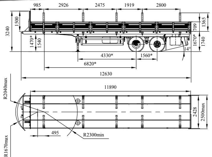
\* Размеры при полной массе полуприцепа
