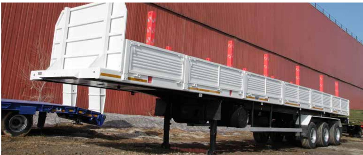
– 9 т, нагрузка на ССУ тягача – 17 т, нагрузка на дорогу через шины – 27 т. Подвеска рессорная балансирующая. **ЧМЗАП 9906.5W0000.038-БTK 11** оснащен съемными бортами, которые можно демонтировать и перевозить на нем длинномерные грузы, кониками, раздвигающимися по ширине, и топливным баком на 500 л. Передний усиленный борт обеспечивает безопасность водителя тягача.
