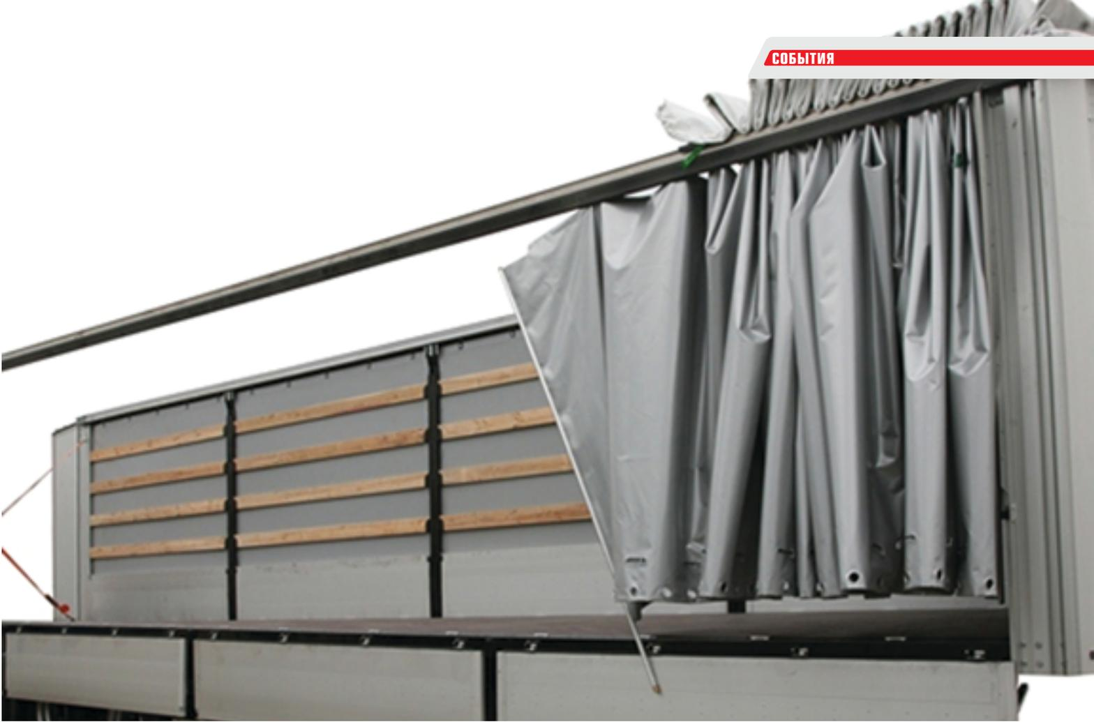
Тентованный полуприцеп представляет собой платформу на трехосном шасси, на которую поставлен каркас, обтянутый прочной синтетической тканью (тентом). Тент полуприцепа прочно фиксируется специальными креплениями и позволяет защитить перевозимый груз от осадков, грязи и пыли. В задней части такого полу-
