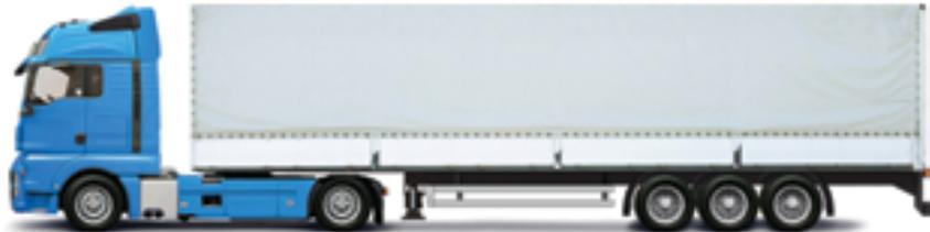
«Еврофура» - это условное понятие, обозначающее седельный тягач с полуприцепом имеющим габаритные размеры и характеристики близкие к следующим: длина - 13,6 м., ширина - 2,45 м., высота - 2,45 м., объём - 82 м<sup>3</sup>, грузоподъёмность - 28 тонны. Приставка «Евро» была получена благодаря тому, что подобный вид транспортной техники (тентованные полуприцепы) первыми начали изготавливать в Европе.
