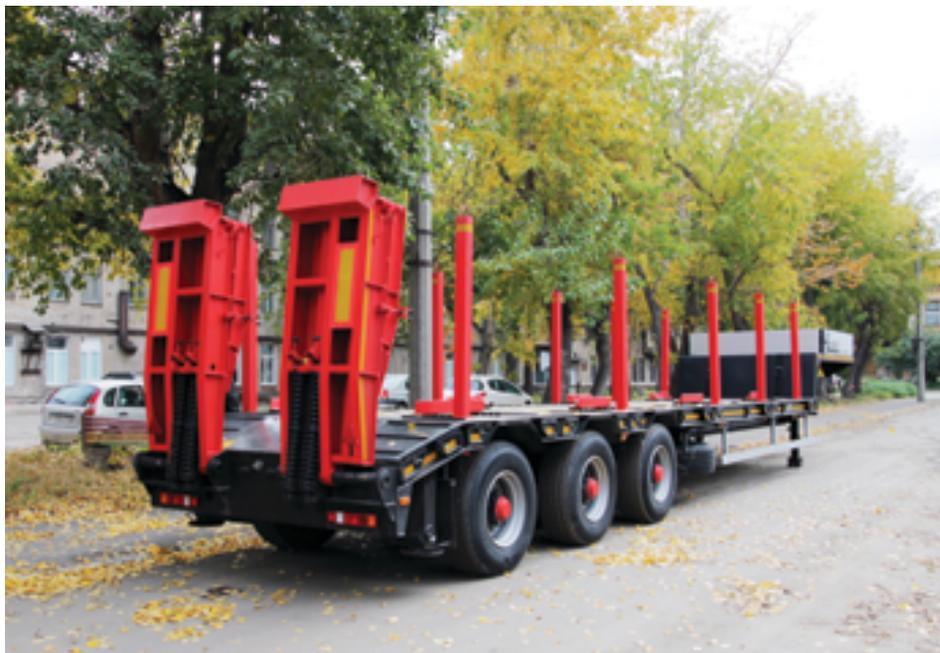
Полуприцеп-тяжеловоз, оборудованный платформой с возможностью заезда спецтехники (с помощью трапов и наклонной части задней рамы), грузоподъемностью 28, 3 т. (Допускается конструкцией - 36 т).
