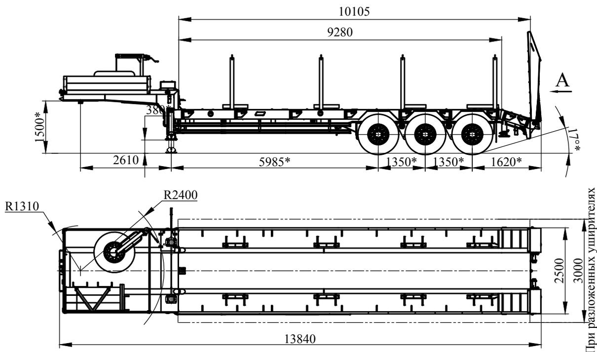
\* Размеры для полуприцепа полной массы
