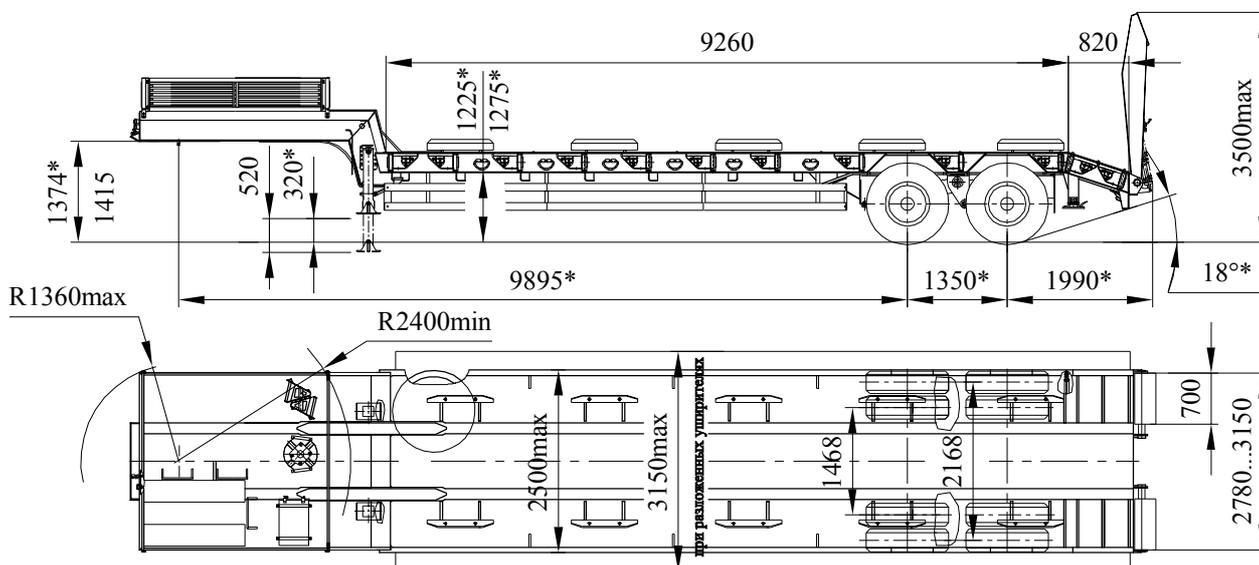
\*Размеры при полной массе полуприцепа
