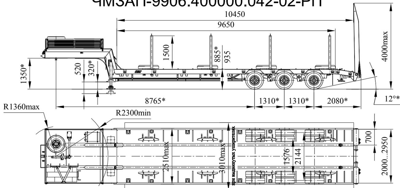
\*Размеры при полной массе полуприцепа
