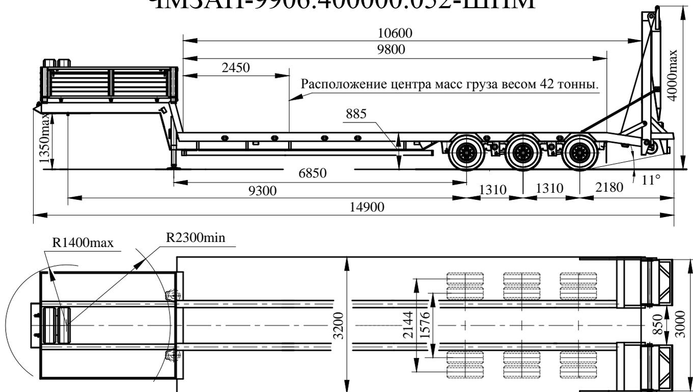
Размеры при полной массе полуприцепа
