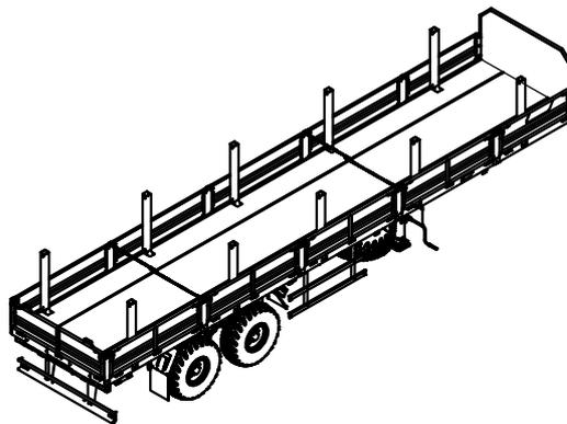
Доп. оборудование: инструментальный ящик, щитки негабаритности, коники 5 пар, петли 4 пары, энергоаккумуляторы, подъемник запасного колеса.
