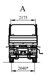
Масса перевозимого груза, кг 32000 Масса снаряженного полуприцепа, кг 9500 Полная масса полуприцепа, кг 41500 Нагрузка на ССУ тягача, кгс 14500 Нагрузка на дорогу через шины, кгс 27000 Количество колес, шт 6+2385/65R22,5 Шины Скорость с грузом макс., км/час 80 Сцепной шкворень, дюймы (мм) 3,5(88,9) Коники 6 пар, обрезиненные Пневматическая Подвеска "Уралавтоприцеп" Оси
