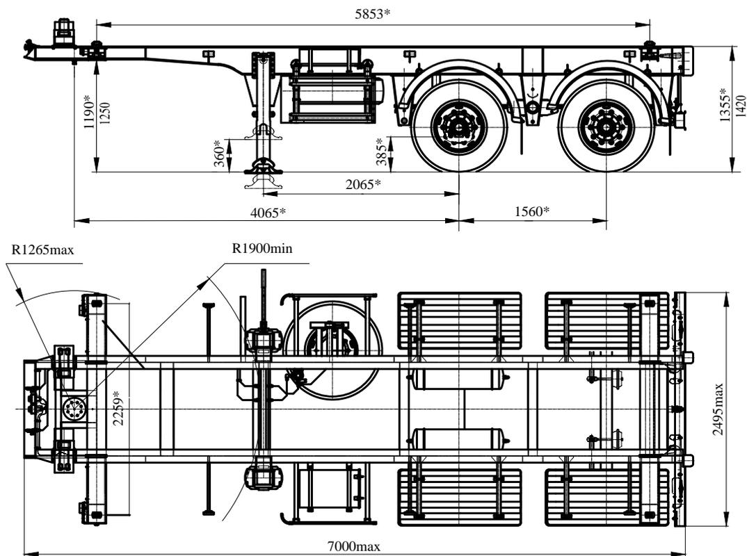
\*Размеры при полной массе полуприцепа
