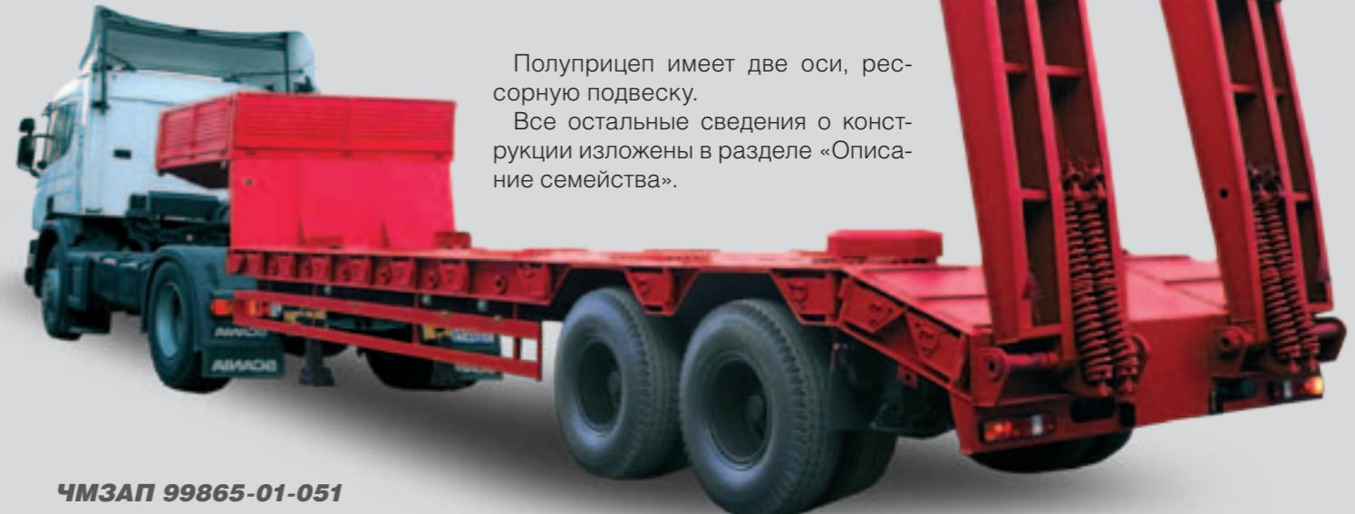
Полуприцеп имеет две оси, рессорную подвеску.
