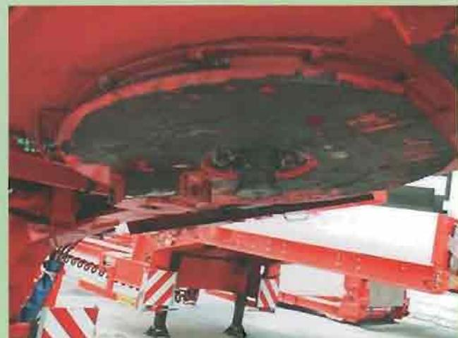
заполнение цилиндров подвески, можно регулировать дорожный просвет и выравнивать платформу при движении с поперечным уклоном.
