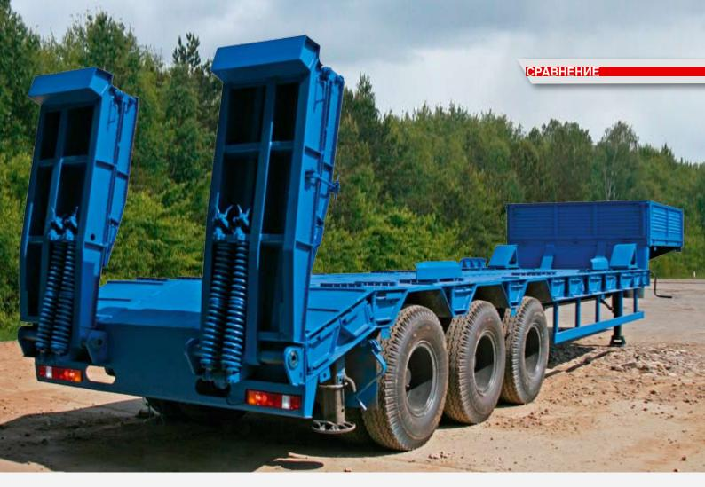
дорожное покрытие через шины. Диаметр сцепного шкворня 3,5". По требованию заказчика полуприцеп может быть снабжён антиблокировочной системой тормозов «Wabco» по схеме 4S/3M.
