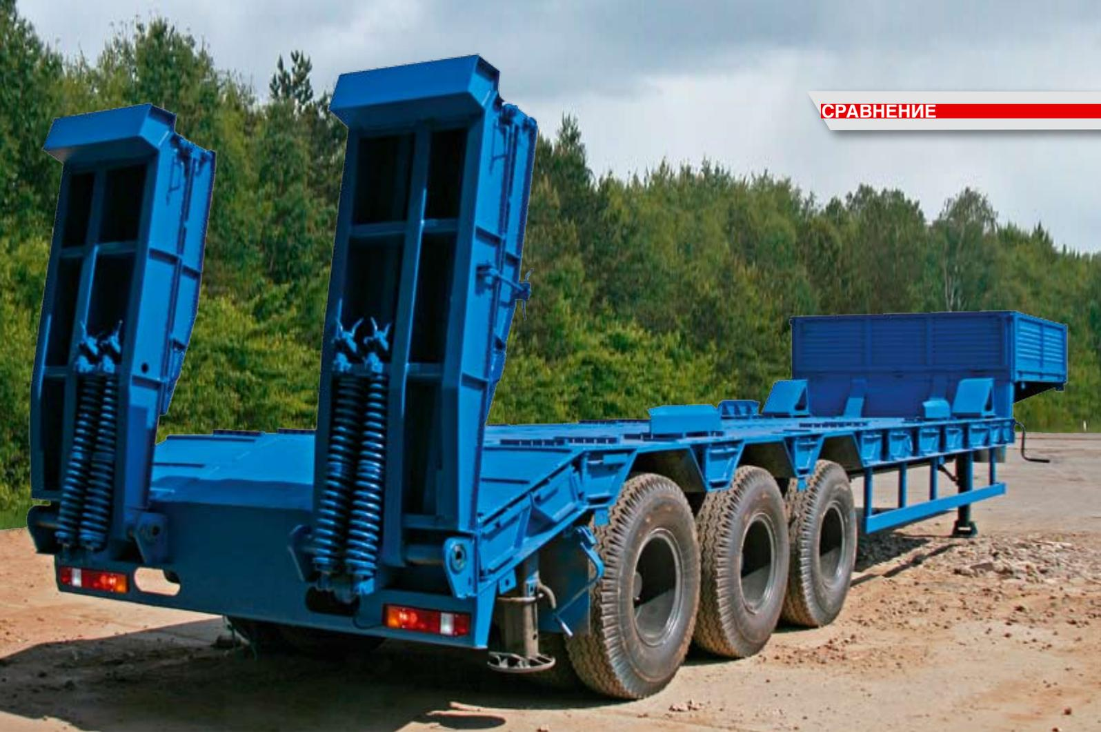
дорожное покрытие через шины. Диаметр сцепного шкворня 3,5". По требованию заказчика полуприцеп может быть снабжён антиблокировочной системой тормозов «Wabco» по схеме 4S/3M.
