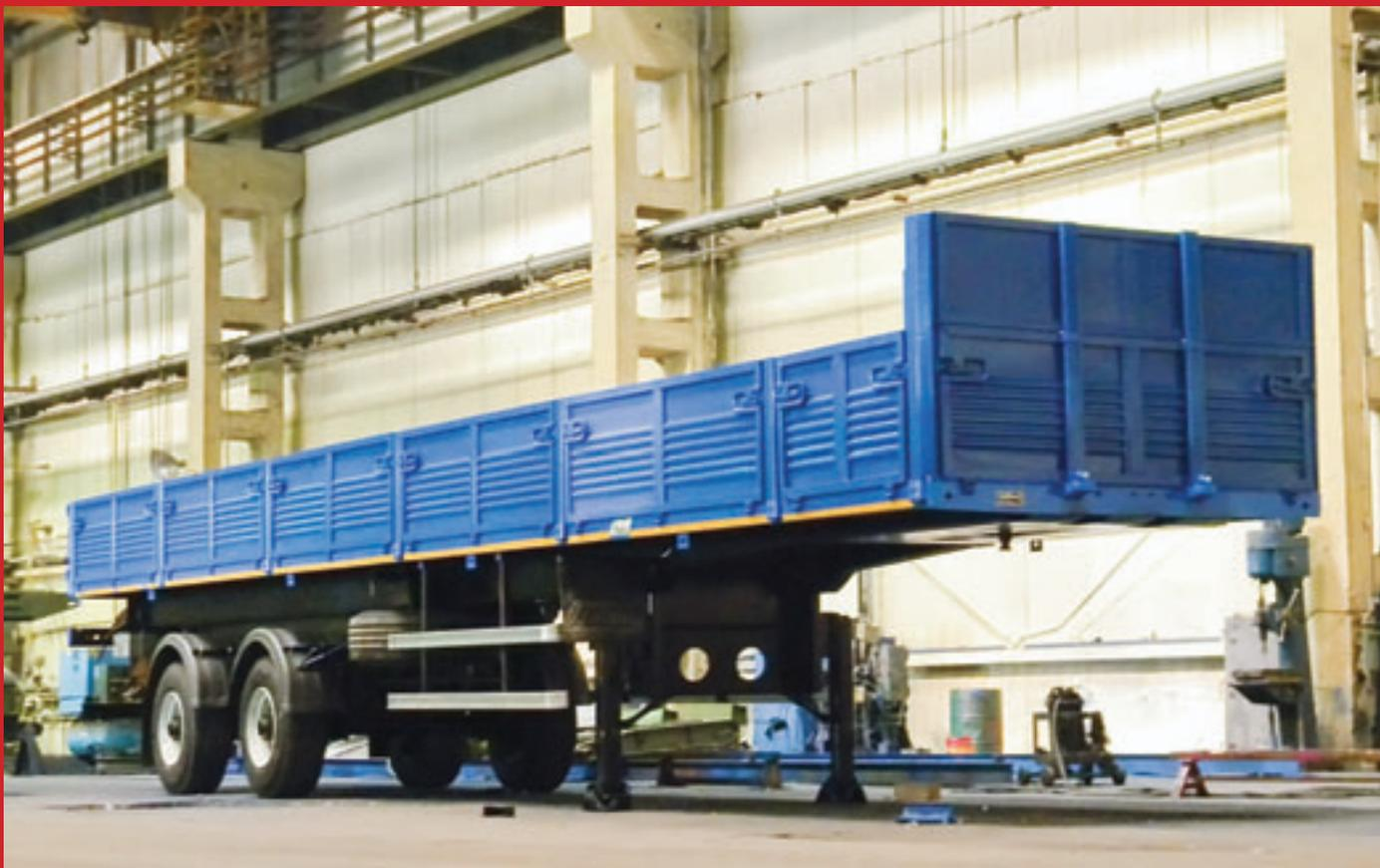
**В.:** У полуприцепа ЧМЗАП 9906 по спецификации 036-ШД при 4+1 колесах грузоподъемность такая же, как у аналогичного прицепа ЧМЗАП 9906 по спецификации 036 с 8+1 колесами.
