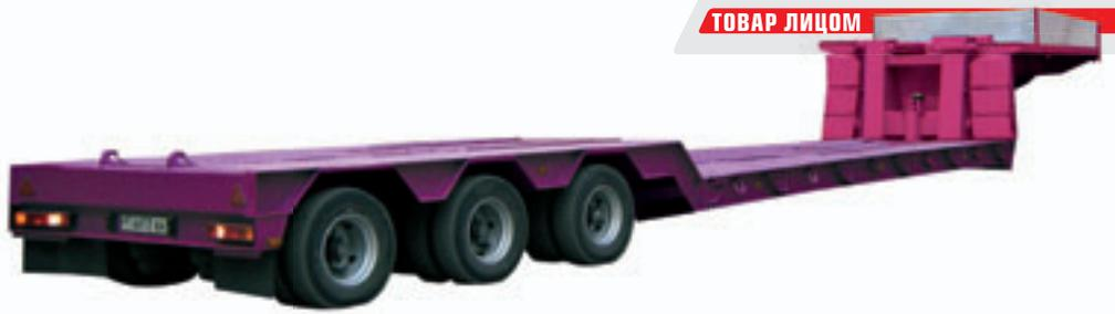
и гидравлическая лебедка с тяговым усилием 6 тонн. Длина троса 27 метров. На полуприцепе установлены двухсекционные въездные трапы шириной 700 миллиметров. Угол въезда по ним 13 градусов. Трапы легко откидываются в рабочее состояние и складываются, благодаря наличию пружинного механизма. Полуприцепы ЧМЗАП-99903-015 могут буксироваться седельными тягачами VOLVO, TATRA, MAZ и многими другими.
