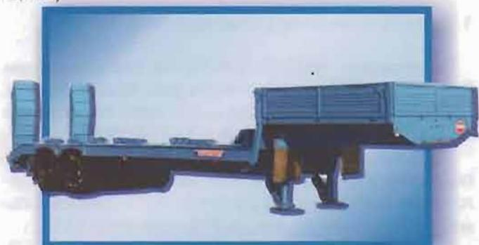
Грузоподъемность полуприцепа 50 тонн, снаряженная масса 15 тонн. Нагрузка на седло тягача 25 тонн, на дорогу через шины 40 тонн.
