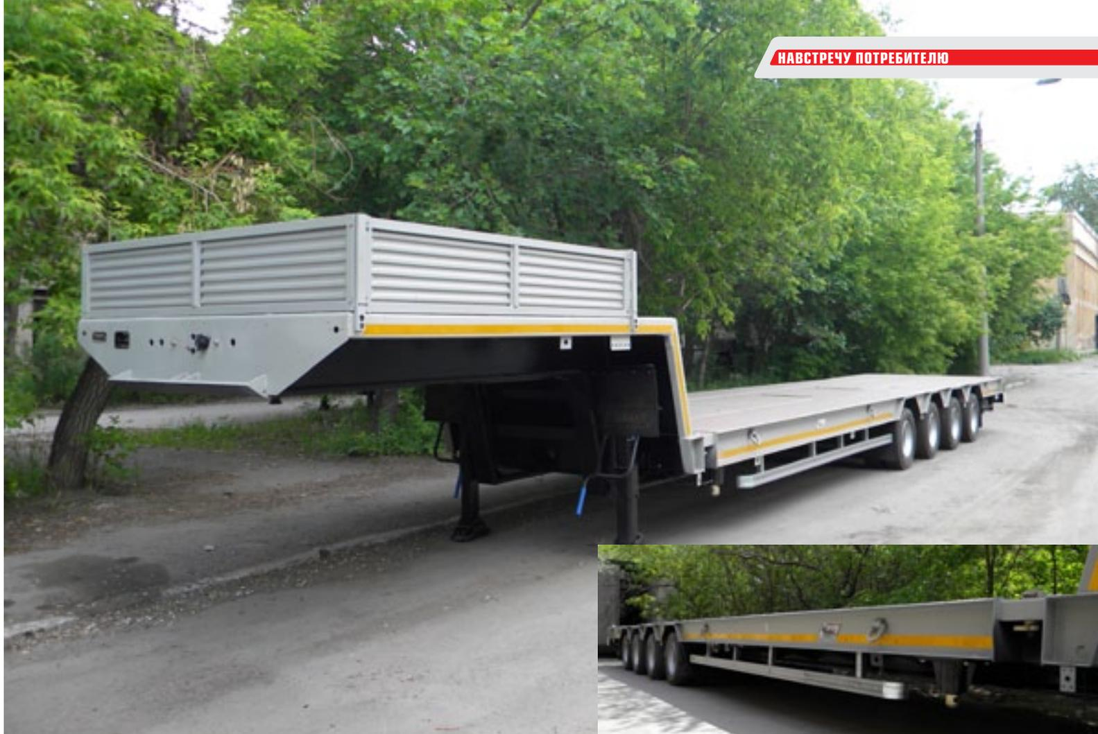
компании из США. Эти тяжеловозы способны перевозить 40 футовые контейнеры «High-Cube», груз крепится с помощью стандартных контейнерных замков. Для долговременной стоянки (1 год и более) на полуприцепе предусмотрены винтовые, регулируемые по высоте, опоры, которые снимают нагрузку со всех колес трала. Длина грузовой платформы 12 200 мм, ширина 2 500 мм. В конструк-
