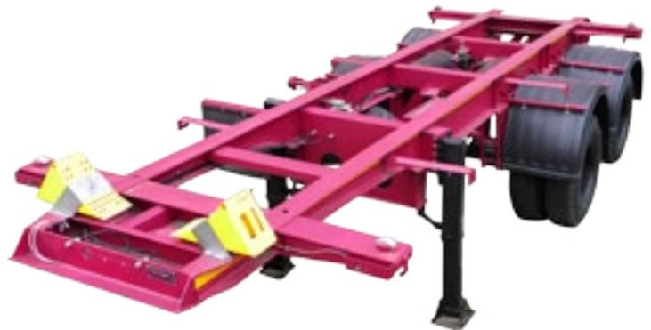
1ССС, 1Х, 1А, 1АА, 1В, 1ВВ и 1В. На базе контейнеровозов ЧМЗАП разработано огромное количество шасси, на которые можно установить цистерны, блок-домики и различное оборудование.
