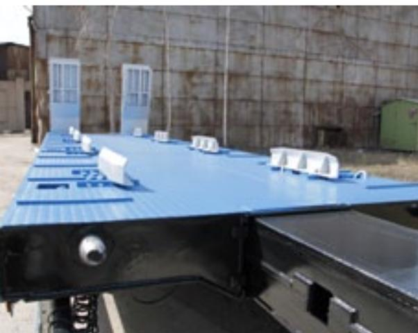
**Четырехосный раздвижной полуприцеп-тяжеловоз ЧМЗАП 99903-035Т** грузоподъемностью 51,5 т. Длина платформы в сдвинутом положении 10040 мм, в раздвинутом 17040 мм. Первые три колесные оси этого полуприцепа-тяжеловоза – неуправляемые, последняя – самоустанавливающаяся. Оснащен выдвижными уширителями платформы и пружинными помощниками подъема-опускания. Шины 235\75 R17,5 141 J. Шкворень 88,9 мм.
