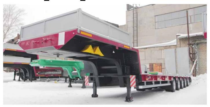
Полуприцеп-тяжеловоз с пониженной высотой грузовой платформы на пневматической подвеске BPW. (Базовая модель — **ЧМЗАП 99904-011 НУ**). Грузоподъемность составляет 60 т. Модель оснащена гидравлическими трапами, обеспечивающими заезд техники под углом 6-8°. В транспортном положении трапы фиксируются специальной стяжкой.
