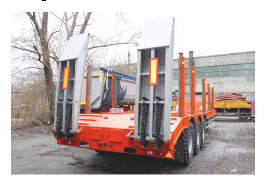
Высокорамный полуприцеп-тяжеловоз **ЧМЗАП 9990-074 К** был разработан для эксплуатации в экстремальных условиях бездорожья и низких температур. Грузоподъемность составляет 70 т. Усиленная рама трехлонжеронного типа обеспечивает исключительную выносливость полуприцепа. **ЧМЗАП 9990-074 К** предназначен для перевозки неделимых негабаритных тяжеловесных грузов и колесно-гусеничной техники.
