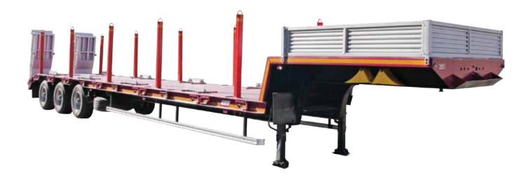
**ЧМЗАП 9906.4-081 КШТ 5** — модификация предыдущей модели: вездеходный полуприцептяжеловоз на рессорной подвеске грузоподъемностью 36 т. Шины 14,00-20 нс 22 мод Бел-64. Длина платформы — 12 000 мм, ширина — 2500 мм (при разложенных уширителях 3 000 мм). Модель оборудована кониками-стойками.
