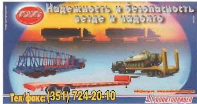
Прицепы и полуприцепы рассчитаны для эксплуатации при безгаражном хранении при температурах окружающей среды от -45°C до +40°C и относительной влажности воздуха до 80% при температуре +15°C, по профицированным дорогам с гравийным и усовершенствованным покрытиями с заходом на временные дороги лесосек.
