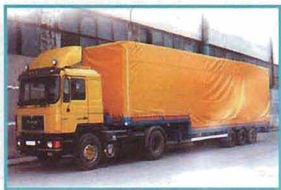
Таким образом, высота ступени (перепад между верхними плоскостями передней и задней частями рамы) составляет 500 мм. Такая конструкция рамы позволяет без нарушения европейского дорожного законодательства иметь объем загрузочного пространства около 100 куб. М.
