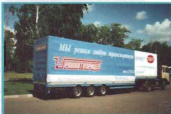
Полуприцеп модели ЧМЗАП-990650 по спецификации 051 отличается от других базовых моделей этого семейства наличием ступенчатой рамы. Передняя часть рамы приподнята на ту же высоту 1250 мм. для сцепки с седлом тягача. А задняя опущена до высоты погрузки 960 мм за счет установки шин малого диаметра размерности 8,25R15.
