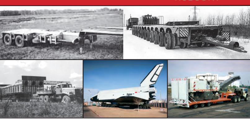
Старт космическому кораблю «Буран» на аэродроме «Юбилейный» на Байконуре обеспечила универсальная ракетно-космическая транспортная система «Энергия», которая была укомплектована модульным прицепом производства ЧМЗАП. Конструкторы завода впервые создали и эксплуатировали на этом прицепе подруливающую подвеску, которая управлялась оператором дистанционно.
